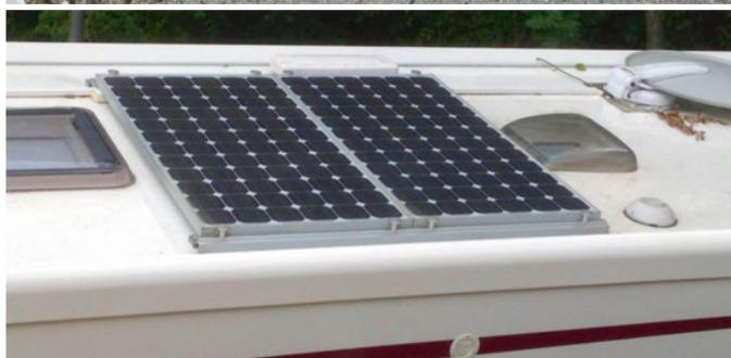
**Ci-dessus, le camping-car de Loïc et ci-contre, celui de Franck. Pour eux, leur vision de l'autonomie, c'est au moins 350 W de panneaux solaires industriels, un chargeur solaire type mppt efficace et au moins 250 A de batteries. Une installation à moins de 1500 € montée avec des batteries acide qui pourra évoluer vers des batteries au lithium ou au sodium quand leurs tarifs seront plus abordables.**
