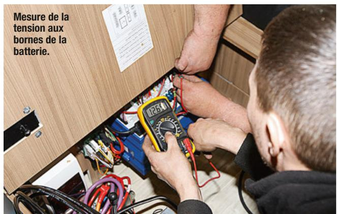
Mesure de la tension aux bornes de la batterie.
