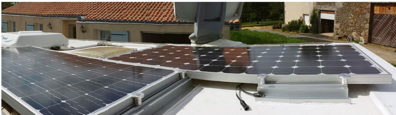
**Panneaux solaires de type industriel 185 W en 40 V montés sur un camping-car avec un régulateur de charge type MPPT rapide.**
